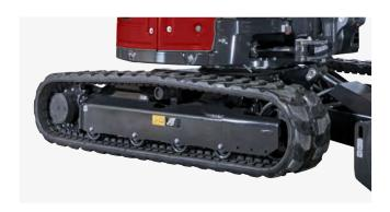
La estructura tubular en forma de X del tren de rodaje ofrece una excelente rigidez torsional. El bastidor está diseñado para durar el máximo tiempo posible.
