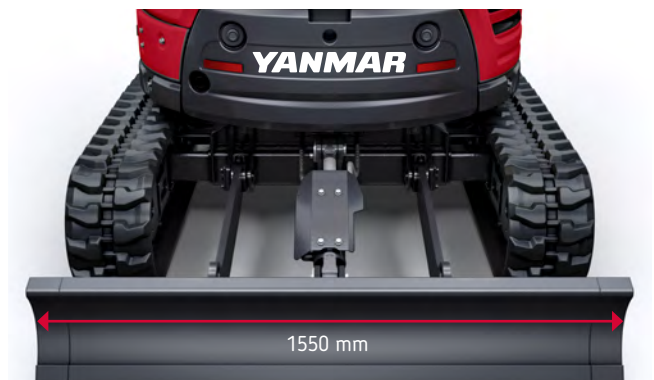
Ampliado: mayor estabilidad para mejorar el rendimiento en labores de excavación y carga
